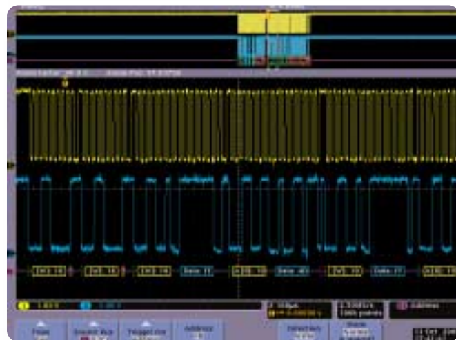
▶ 그림 7. \text{I}^2\text{C} 주소 및 데이터 버스 파형 디코딩
