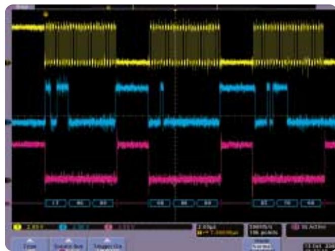
▶ 그림 12. SPI 버스의 합성기 구성 메시지 획득
